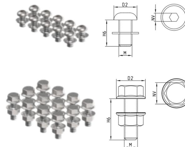
Alle Maße in mm. Enthält Stellfüße, Muttern, Schrauben und Dichtungen wie gezeigt.
