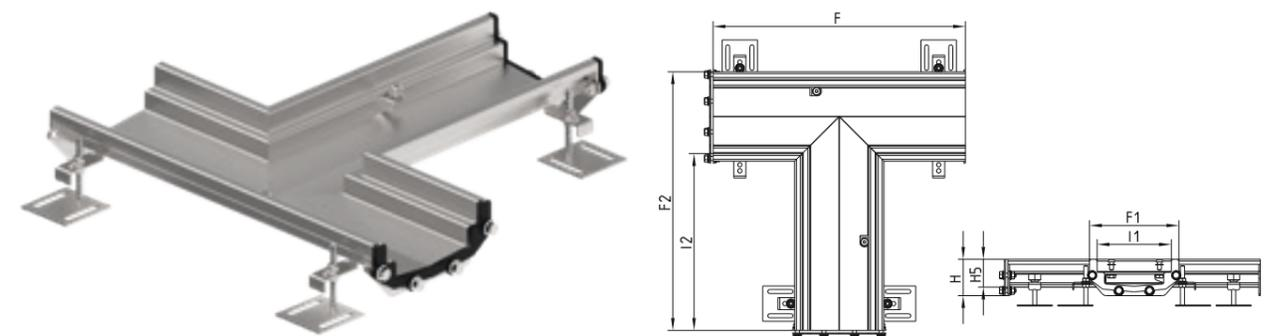
Alle Maße in mm. Enthält Stellfüße, Muttern, Schrauben und Dichtungen wie gezeigt.
